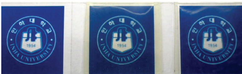
Fig. 11. Visual appearance of TPU/O-MMT nanocomposite films: a) TPU, b) TPU/3wt% O-MMT, c) TPU/5 wt% O-MMT.
